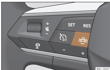
Obr. 100 Levá strana multifunkčního volantu: tlačítko asistenčních systémů řídiče (v závislosti na modelu).
