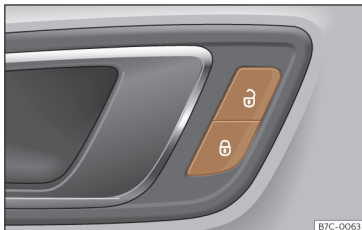
Obr. 49 Ve dveřích řidiče: tlačítko centrálního zamykání.
