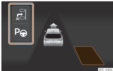
Obr. 132 Na displeji panelu přístrojů: zobrazení parkovacího asistenta s omezeným výhledem.
