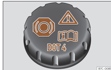
Obr. 195 Motorový prostor: uzávěr nádržky brzdové kapaliny
