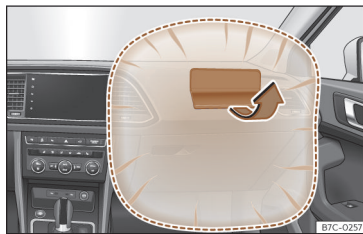
Obr. 24 Airbag spolujezdce v přístrojové desce.
