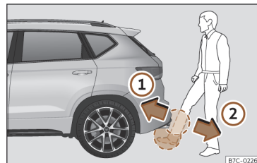
Obr. 57 Zadní víko se snímači řízeným otvíráním a zavíráním (Easy Open).
