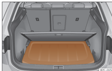
Obr. 160 V zavazadlovém prostoru: vložení krytu zavazadlového prostoru.
