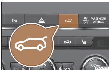
Obr. 56 Středová konzola: tlačítko pro otvírání a zavírání zadního víka.
