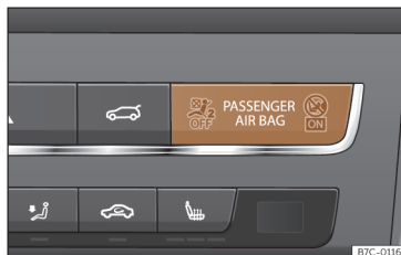
Obr. 26 Přístrojová deska: kontrolka deaktivovaného airbagu spolujezdce.
