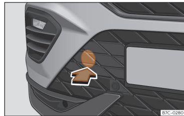
Obr. 183 Na pravé straně předního nárazníku: odstranění krytu.
