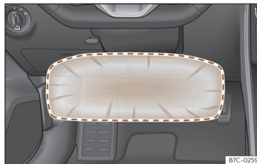
Obr. 31 Na straně řidiče: oblast působnosti kolenního airbagu.
