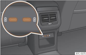
Obr. 150 Středová konzola vzadu: Přípojky USB s funkcí zásuvky.
