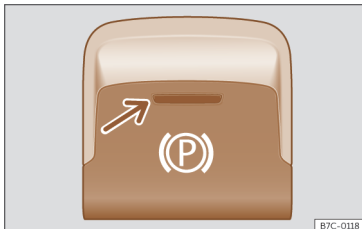
Obr. 124 Ve spodní oblasti středové konzoly: tlačítko elektronické parkovací brzdy.
