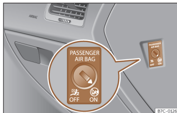
Obr. 25 Klíčem ovládaný spínač pro připojení a odpojení airbagu spolujezdce.
