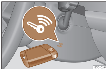
Obr. 90 Vpravo na sloupku řízení: nouzový start.
