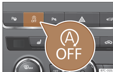
Obr. 91 Středová konzola: tlačítko systému start-stop.
