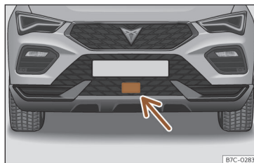
Obr. 101 V předním nárazníku: radarový snímač.
