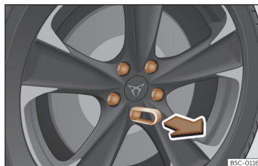
Obr. 207 Kolo: šrouby kola s víkem.
