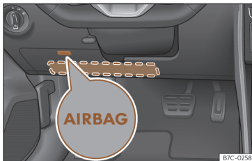
Obr. 30 Na straně řidiče: montážní místo kolenního airbagu.
