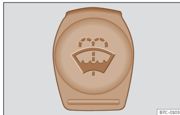
Obr. 196 V motorovém prostoru: modrý uzávěr nádržky ostřikovací kapaliny.
