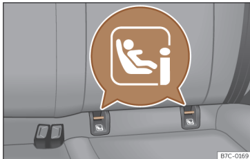
Obr. 35 Zadní sedadlo: Montážní místo přídržných ok pro ISOFIX nebo i-Size.
