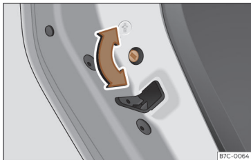
Obr. 53 Dětská pojistka v levých dveřích.
