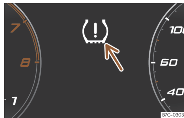
Obr. 238 Panel přístrojů: výstraha pro ztrátu tlaku v pneumatice.
