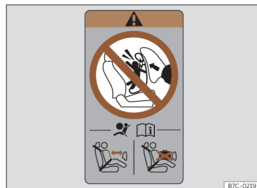
Obr. 40 Štítek airbagu: na horním rámu dveří spolujezdce.
