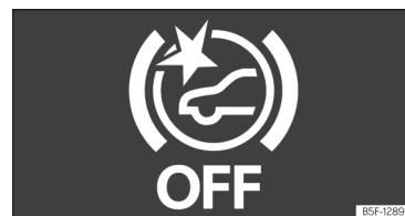
Obr. 136 Na displeji panelu přístrojů: signalizace vypnutí systému Front Assist.
