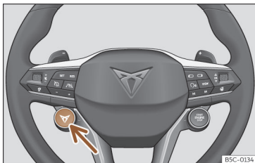
Obr. 117 Multifunkční volant: spínač změny jízdního profilu.
