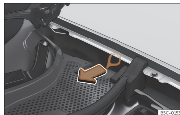
Obr. 59 Mezi levým blatníkem a závěsem víka motorového prostoru: tažná rukojeť ručního odjištění nabíjecího konektoru.
