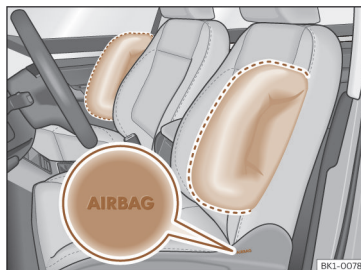
Obr. 33 Boční airbag v sedadlech řidiče a spolujezdce.
