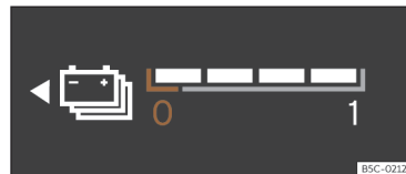
Obr. 5 Digitální panel přístrojů: signalizace stavu nabití akumulátoru.
