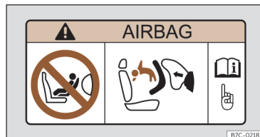
Obr. 39 Štítek airbagu: na sluneční cloně.
