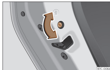
Obr. 74 Dětská pojistka v levých dveřích.
