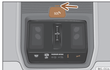
Obr. 50 Ve stropní konzole: spínač hlasových služeb.
