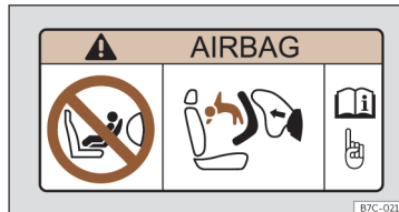
Obr. 29 Nálepka pro airbag: na sluneční cloně na straně spolujezdce
