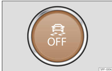
Obr. 189 Ve spodní části středové konzoly: tlačítko k zapnutí/vypnutí funkce ESC
