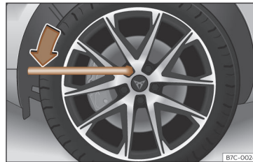
Obr. 41 Výměna kola: povolení šroubů kola.
