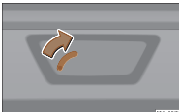
Obr. 91 Detail zavazadlového prostoru: nouzové odemykání (Leon Sportstourer).
