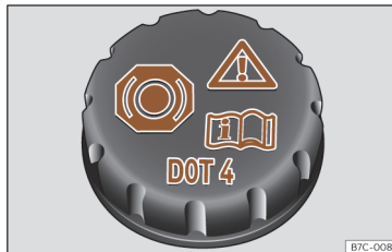
Obr. 225 Motorový prostor: uzávěr nádoby brzdové kapaliny.
