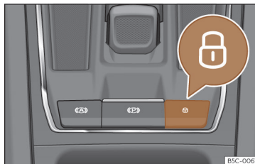
Obr. 80 Ve středové konzole: tlačítko centrálního zamykání dveří
