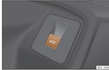
Obr. 88 U dveří řidiče: tlačítko pro otvírání a zavírání zadního víka.
