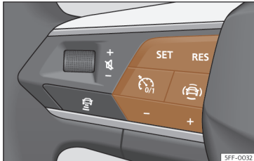
Obr. 166 Na multifunkčním volantu: tlačítka k ovládání tempomatu
