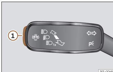
Obr. 65 Na páčce směrových světel a dálkových světel: tlačítko asistenčních systémů řidiče (v závislosti na modelu).
