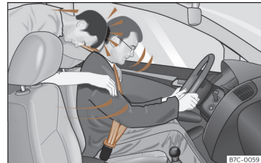
Obr. 12 Nepřipoutaný cestující na zadním sedadle je vymrštěn dopředu na připoutaného řidiče.
