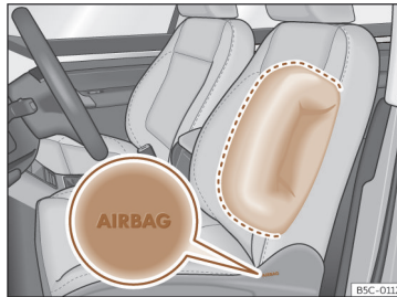
Obr. 25 Boční airbag v sedadle řidiče
