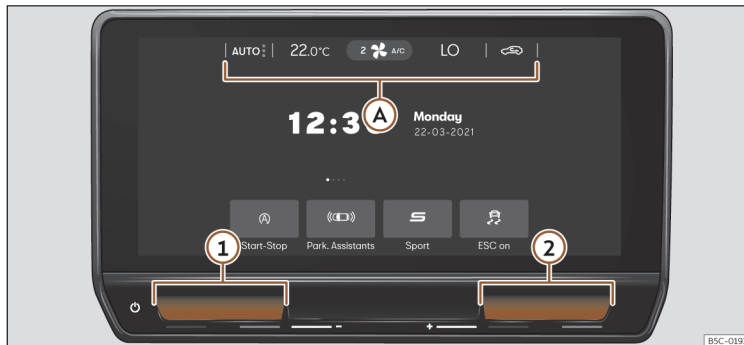
Obr. 143 Schématické zobrazení: funkce klimatizování
