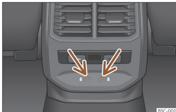
Obr. 153 Středová konzola vzadu: Přípojky USB s funkcí zásuvky.
