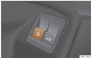
Obr. 212 Dveře řidiče: odjištění víka plnicího hrdla palivové nádrže.
