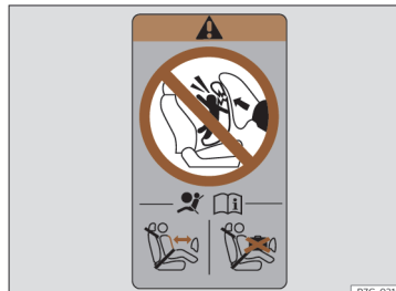
Obr. 30 Nálepka pro airbag: v zadní části rámu dveří spolujezdce
