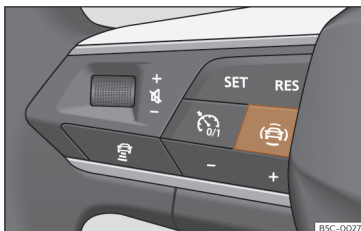
Obr. 66 Levá strana multifunkčního volantu: tlačítko asistenčních systémů řidiče (v závislosti na modelu).
