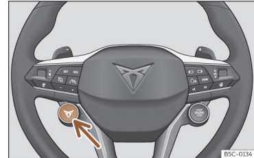
Obr. 159 Multifunkční volant: spínač změny jízdního profilu
