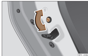
Obr. 85 Dětská pojistka v levých dveřích
