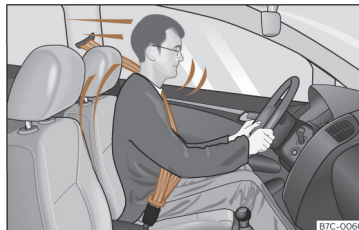
Obr. 10 Řidiči se správně připnutými pásy nebudou při náhlém brzdění vymrštěni dopředu.
