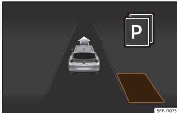
Obr. 190 Na displeji panelu přístrojů: Zobrazení parkovacího asistenta s omezenou viditelností.
