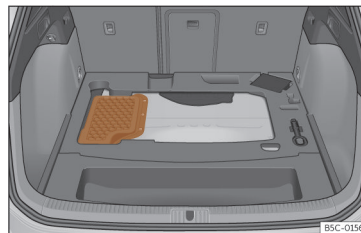
Obř. 227 Plug-in hybridní vozidla (PHEV): montážní místo akumulátoru v zavazadlovém prostoru
