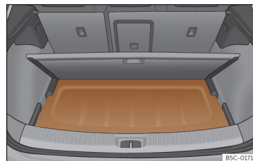
Obr. 118 V zavazadlovém prostoru: Vložení krytu zavazadlového prostoru.
