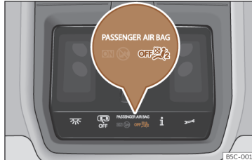
Obr. 20 Ve stropní konzole: kontrolka odpojení airbagu spolujezdce.
