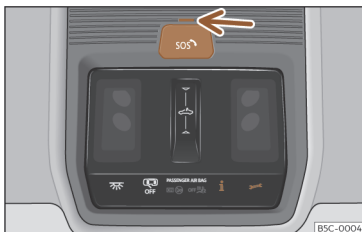
Obr. 36 Ve stropní konzole: spínač hovorových služeb
