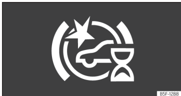
Obr. 169 Na displeji panelu přístrojů: signalizace první automatické kalibrace systému.
