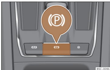
Obr. 187 Ve spodní části středové konzoly: tlačítko elektronické parkovací brzdy.
