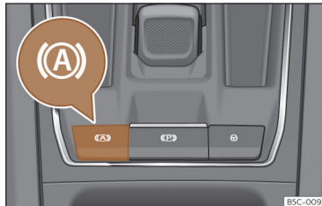
Obr. 188 Ve spodní části středové konzoly: tlačítko funkce Auto Hold.
