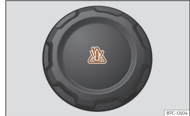
Obr. 224 Motorový prostor: uzávěr vyrovnávací nádobky chladicí kapaliny motoru.
