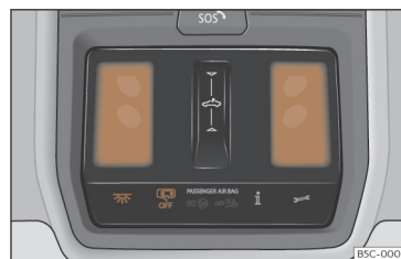
Obr. 98 Detail stropního panelu: osvětlení vnitřního prostoru vpředu.
