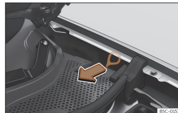
Obr. 208 Mezi levým blatníkem a závěsem víko motorového prostoru: tažná rukojeť ručního odjistižování nabíjecího konektoru.
