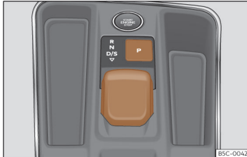
Obr. 157 Ve středové konzole: volicí páka.
