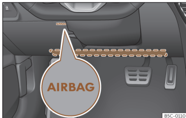
Obr. 21 Na straně řidiče: montážní místo kolenního airbagu.
