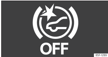
Obr. 170 Na displeji panelu přístrojů: signalizace vypnutí systému Front Assist.
