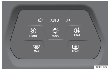
Obr. 95 Přístrojová deska: spínač světel.
