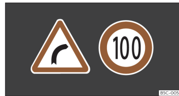
Obr. 58 Na displeji panelu přístrojů: příklad rozpoznané dopravní značky.
