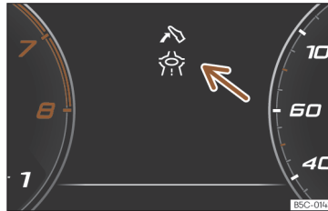
Obr. 59 Signalizace asistenta pro ekologický způsob jízdy (schématické znázornění).
