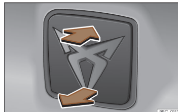
Obr. 86 Zadní víko: otevření zvenku.
