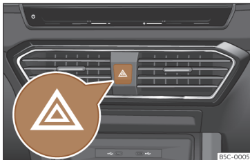
Obr. 97 Přístrojová deska: spínač výstražných světel.
