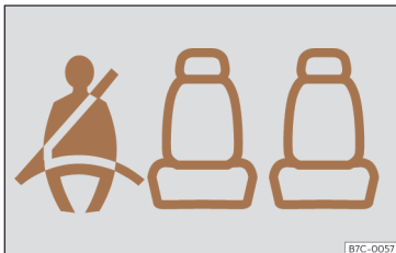
Obr. 9 Panel přístrojů: Zobrazení, že místo vzadu vlevo je obsazeno a spolucestující má připnutý bezpečnostní pás.
