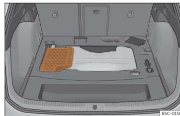
Obr. 229 Plug-in hybridní vozidla (PHEV): montážní místo akumulátoru v zavazadlovém prostoru
