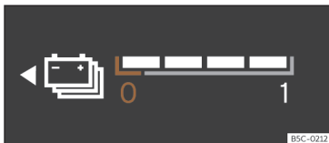
Obr. 63 Volně konfigurovatelný panel přístrojů: signalizace stavu nabití akumulátoru.
