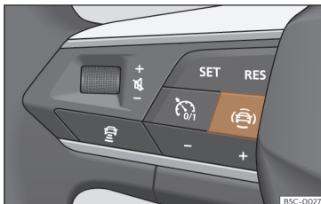
Obr. 67 Levá strana multifunkčního volantu: tlačítko asistenčních systémů řidiče (v závislosti na modelu).
