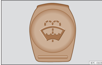
Obr. 219 V motorovém prostoru: modrý uzávěr nádrčky ostřikovací kapaliny.
