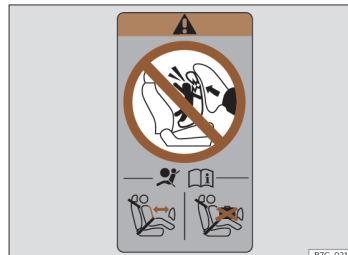
Obr. 40 Štítek airbagu: na horním rámu dveří spolujezdce.
