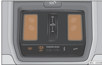
Obr. 101 Výřez stropního panelu: vnitřní osvětlení vpředu.
