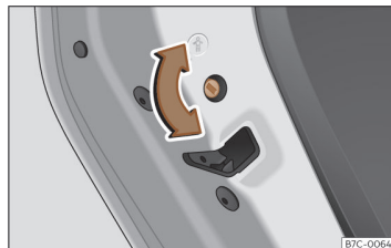
Obr. 74 Dětská pojistka v levých dveřích.
