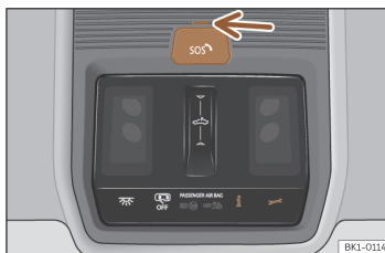
Obr. 50 Ve stropní konzole: spínač hlasových služeb.
