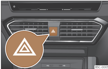
Obr. 49 Přístrojová deska: spínač výstražných světel.
