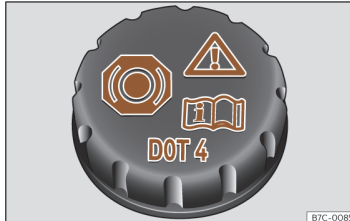
Obr. 218 Motorový prostor: uzávěř nádržky brzdové kapaliny
