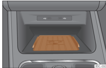
Obr. 170 Ve středové konzole: úchyt pro spráhnutí mobilního telefonu.
