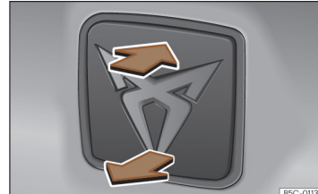
Obr. 75 Zadní víko: otvírání zvenku
