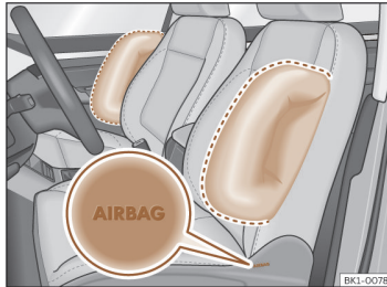
Obr. 33 Boční airbag v sedadlech řidiče a spolujezdce.
