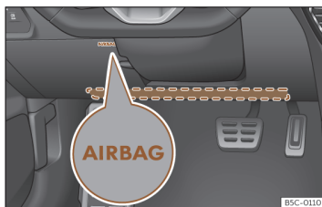
Obr. 36 Na straně řidiče: montážní místo kolenního airbagu.
