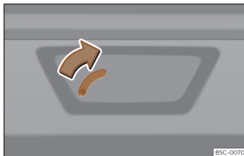
Obr. 80 Detail zavazadlového prostoru: nouzové odemýkání (Leon Sportstourer).
