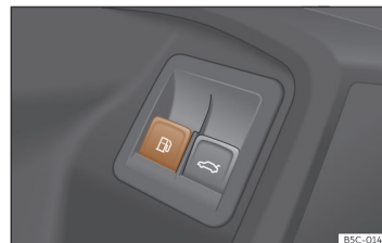
Obr. 200 Dveře řidiče: odjistění víka plnicího hrdla palivové nádrže.
