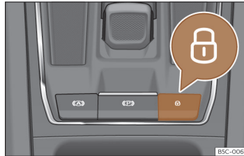
Obr. 71 Ve středové konzole: Tlačítko centrálního zamykání
