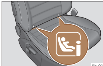
Obr. 42 Sedadlo spolujezdce: Montážní místo přídržných ok pro i-Size.
