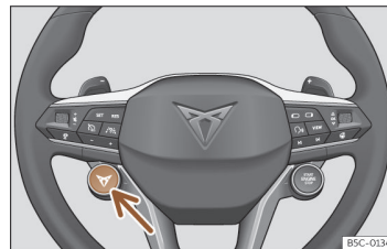
Obr. 117 Multifunkční volant: spínač změny jízdniho profilu.
