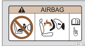
Obr. 39 Štítek airbagu: na sluneční cloně.
