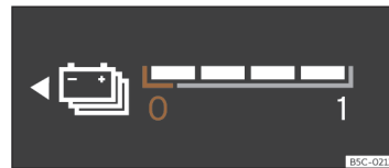
Obr. 5 Digitální panel přístrojů: signalizace stavu nabití akumulátoru.
