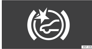
Obr. 134 Na displeji panelu přístrojů: upozornění předběžné výstrahy.
