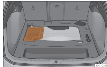
Obr. 224 Plug-in hybridní vozidla (PHEV): montážní místo akumulátoru v zavazadlovém prostoru
