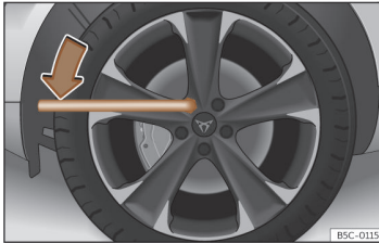
Obr. 233 Výměna kola: Povolení šroubů kola
