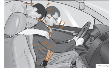
Obr. 22 Nepřipoutaný spolujezdec na zadním sedadle je vymršťen směrem dopředu na připoutaného řidiče.
