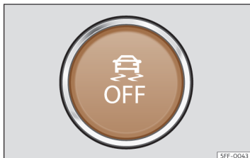
Obr. 118 Ve spodní oblasti středové konzoly: tlačítko k zapnutí/vypnutí funkce ESC
