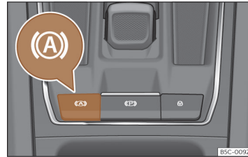
Obr. 146 Ve spodní oblasti středové konzoly: tlačítko funkce AutoHold.
