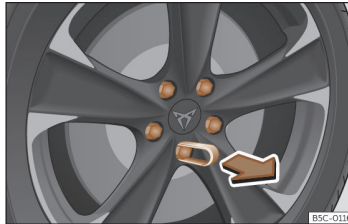
Obr. 231 Kolo: šrouby kola s víkem.
