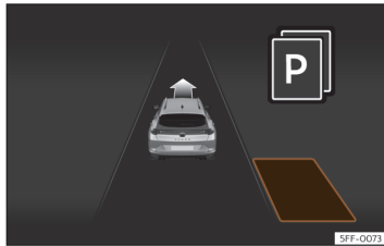
Obr. 149 Na displeji panelu přístrojů: zobrazení parkovacího asistenta s omezeným výhledem.
