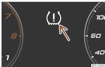
Obr. 236 Panel přístrojů: výstraha pro ztrátu tlaku v pneumatice.
