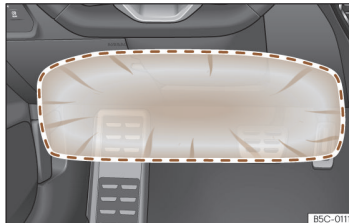
Obr. 37 Na straně řidiče: oblast působnosti kolenního airbagu.
