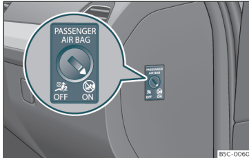
Obr. 19 Klíčem ovládaný spínač pro připojení a odpojení airbagu spolujezdce.
