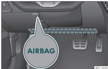
Obr. 21 Na straně řidiče: montážní místo kolenního airbagu.
