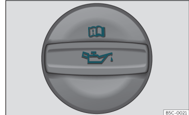
Obr. 216 Uzávěr plicního otvoru motorového oleje
