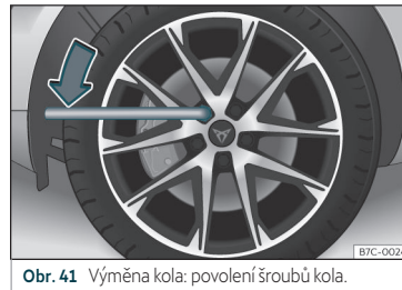
Obr. 41 Výměna kola: povolení šroubů kola.
