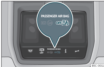
Obr. 20 Ve stropní konzole: kontrolka odpojení airbagu spolujezdce.
