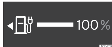
Obr. 62 Volně konfigurovatelný panel přístrojů: signalizace stavu nabití akumulátoru.
