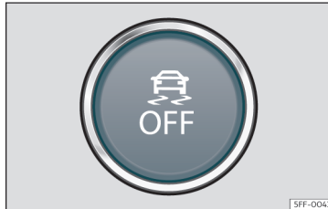
Obr. 188 Ve spodní části středové konzoly: tlačítko k zapnutí/vypnutí funkce ESC
