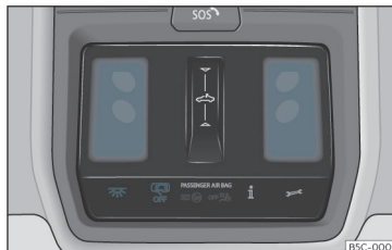
Obr. 97 Detail stropního panelu: osvětlení vnitřního prostoru vpředu.
