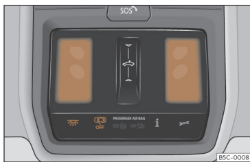
Obr. 101 Výřez stropního panelu: vnitřní osvětlení vpředu.
