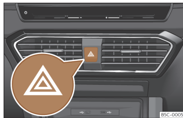
Obr. 49 Přístrojová deska: spínač výstražných světel.
