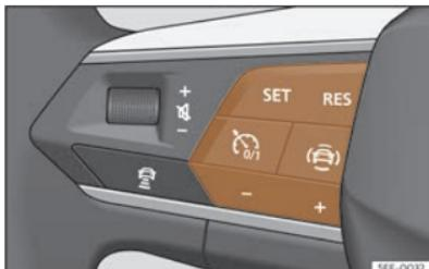
Sl. 129 Na višenamjenskom kolu upravljača: tipke za rukovanje sustavom za ograničenje brzine.
