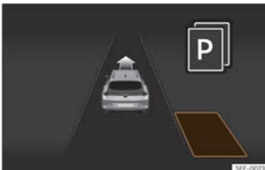
Sl. 150 Na ekranu kombiniranog instrumenta: prikaz potpore upravljanja pri parkiranju s ograničenom vidljivošću.
