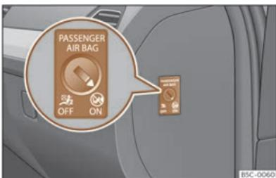
**Sl. 29** Bravica za uključivanje i isključivanje suvozačevog zračnog jastuka.<sup>1)</sup>
