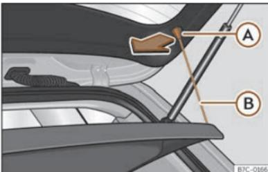
Sl. 173 U prtljažniku: demontiranje i montiranje pokrovke prtljažnika.
