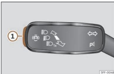
**Sl. 120** Na ručici za žmigavce i duga svjetla: tipka sustava potpore za vozača (ovisno o modelu).
