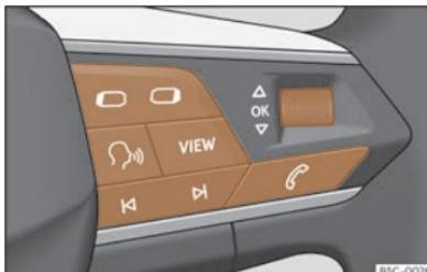
Sl. 11 Desna strana višenamjenskog kola upravljača: elementi za rukovanje izbornicima i informacijskim pokazivačima u kombiniranom instrumentu (ovisno o modelu).
