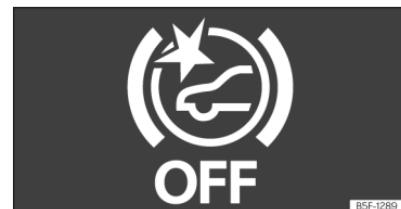
**SI. 137** Na zaslonu kombiniranog instrumenta: prikaz da je Front Assist isključen.
