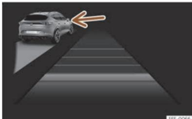
**Sl. 132** Na ekranu kombiniranog instrumenta: ACC aktivran, prepozнатo vozilo na lijevoj strani.
