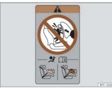
Sl. 40 Etiketa zračnog jastuka: na stražnjem okviru suvozačevih vrata.
