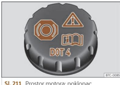
**Sl. 211** Prostor motora: poklopac spremnika kočione tekućine.
