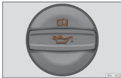
Sl. 216 Poklopac otvora za ulijevanje motornog ulja u prostoru motora.
