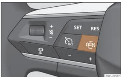
**Sl. 121** Ljeva strana višenamjenskog kola upravljača: tipka sustava potpore za vozača (ovisno o modelu).
