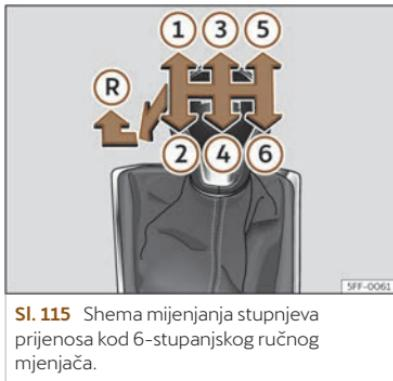
**Sl. 115** Shema mijenjanja stupnjeva prijenosa kod 6-stupanjskog ručnog mjenjača.
