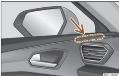
Sl. 142 Kontrolna žaruljica potpore pri promjeni voznog traka.
