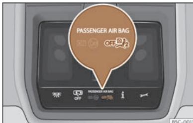
**Sl. 30** U krovnoj konzoli: kontrolna žaruljica za zračni jastuk na suvozačevoj strani isključena.
