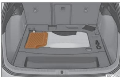
**Sl. 217** Plug-in hibridna vozila (PHEV): mjesto ugradnje akumulatora u prtljažniku
