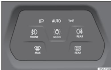
SI. 99 Instrumentna ploča: element za rukovanje svjetlom
