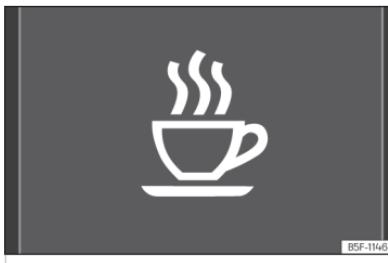
**Sl. 8** Na zaslонu kombiniranog instrumenta: simbol sustava prepoznavanja umora.
