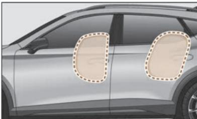
Sl. 34 Kompletno napuhani bočni zračni jastuk na lijevoj strani vozila
