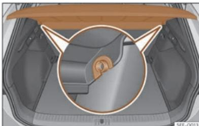
Sl. 174 U prtljažniku: demontiranje i montiranje pokrovke prtljažnika.
