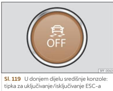
Sl. 119 U donjem dijelu središnje konzole: tipka za uključivanje/isključivanje ESC-a
