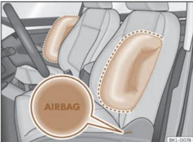
Sl. 33 Bočni zračni jastuk u vozačevom i suvozačevom sjedalu.
