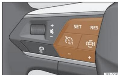
**Sl. 128** Na višenamjenskom kolu upravljača: Tipke za rukovanje uređajem za reguliranje brzine.
