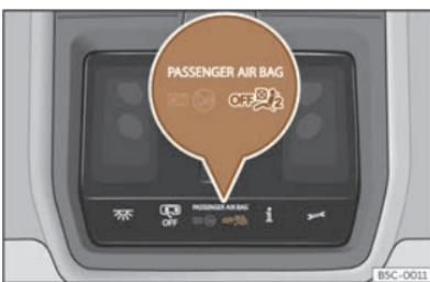
Sl. 44 U krovnoj konzoli: kontrolna žaruljica za zračni jastuk na suvozačevoj strani isključena.
