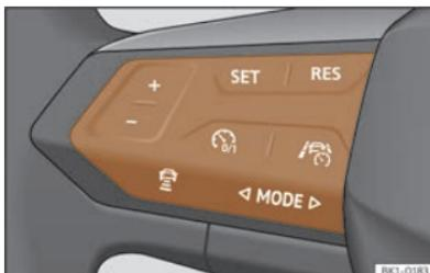
SI. 124 Na višenamjenskom kolu upravljača: tipke za rukovanje sustavom za ograničenje brzine.
