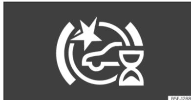
**Sl. 131** Na zaslonu kombiniranog instrumenta: prikaz prvog samostalnog kalibriranja sustava.
