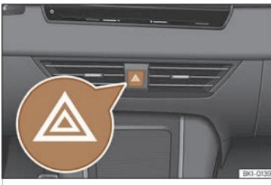
**Sl. 60** Instrumentna ploča: prekidač uređaja za svjetlosno upozorenje
