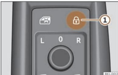
Sl. 85 U vozačevim vratima: prekidač centralnog zaključavanja.
