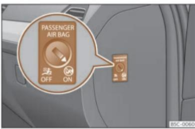
Sl. 43 Bravica za uključivanje i isključivanje suvozačevog zračnog jastuka.
