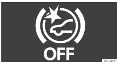
**Sl. 132** Na zaslonu kombiniranog instrumenta: prikaz da je Front Assist isključen.
