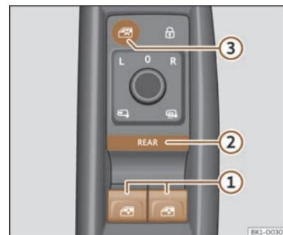
**Sl. 91** Isječak iz vozačevih vrata: tipke za rukovanje električnim podizačima prozora
