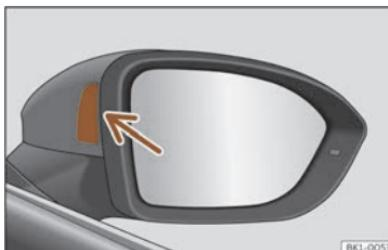
Sl. 138 Kontrolna žaruljica potpore pri promjeni voznog traka.
