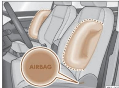
Sl. 47 Bočni zračni jastuk u vozačevom i suvozačevom sjedalu.
