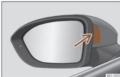
Sl. 137 Kontrolna žaruljica potpore pri promjeni voznog traka.
