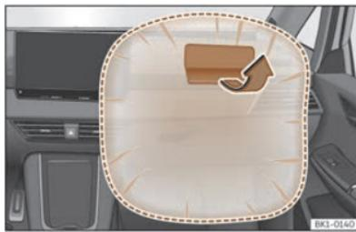
Sl. 42 Suvozačev zračni jastuk u instrumentnoj ploči
