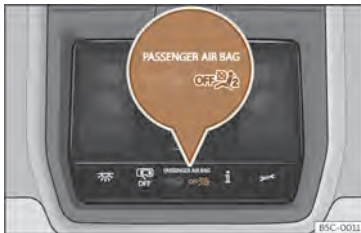
Sl. 16 V stropni konzoli: kontrolna lučka za deaktivirano sovoznikovo čelno varnostno blazino.
