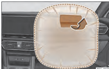
Sl. 14 Sovoznikova varnostna blazina v armaturni plošči.
