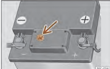
Sl. 218 Vidno okence na zgornji strani 12-voltnega akumulatorja (shematski prikaz).
