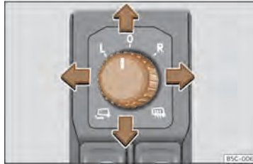
Sl. 99 Del voznikovih vrat: vrtljivi gumb za upravljanje zunanjih vzvratnih ogledal
