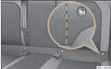
Sl. 27 Zadnji sedež: utor z izrezom za dostop do sidrnih točk sistema ISOFIX/i-Size.
