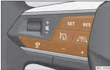
Sl. 167 Leva stran večfunkcijskega volana: tipke za upravljanje asistence Travel Assist.
