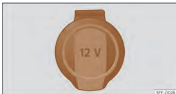
Sl. 127 12-voltna električna vtičnica: ① v notranjosti sprednjega naslona za roke.
