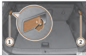
Sl. 109 V prtljažniku: ročici za sprostitev naslonjala zadnje sedežne klopi.
