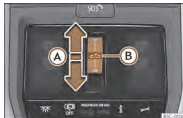
Sl. 89 V stropni oblogi: tipka za panoramsko pomično strešno okno.
