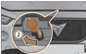
Sl. 206 Ročica pod pokrovom motornega prostora.
