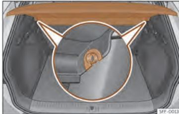
Sl. 112 V prtljažniku: odstranjevanje in nameščanje zadnje police
