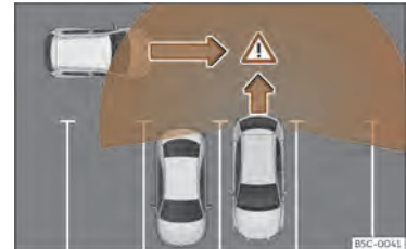
Sl. 172 Shematski prikaz delovanja opozorila na prečni promet zadaj: zaznano območje okrog vozila, ki speljuje.
