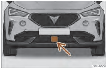
Sl. 148 V sprednjem odbijaču: radarski senzor
