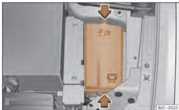
Sl. 48 V motornem prostoru: pokrov postaje z varovalkami.
