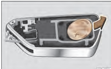
Sl. 74 Ključ vozila: odstranjevanje baterije.
