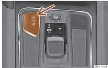
Sl. 71 Sredinska konzola: nastavek za ključ vozila.
