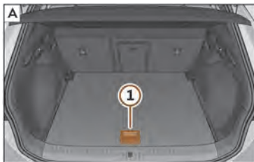
Sl. 116 Variabilno dno prtljažnika: v nagnjenem položaju
