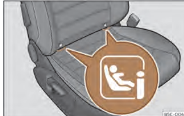
Sl. 28 Sovznikov sedež: sidrni točki sistema ISOFIX/i-Size.
