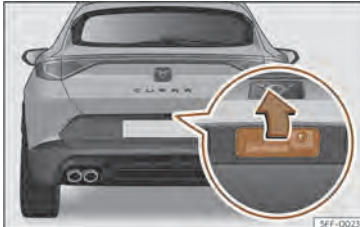
Sl. 82 Vrata prtljažnika: odpiranje z zunanje strani.
