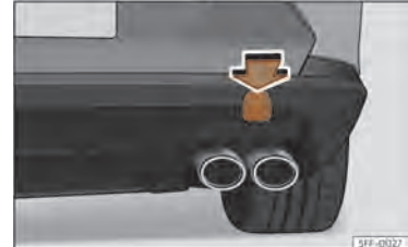
Sl. 45 Zadnji odbijač, desna stran: odstranjevanje pokrovčka.
