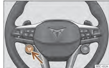
Sl. 147 Večfunkcijski volan: tipka za menjavo voznega profila.
