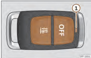
Sl. 132 Ogrevanje mirujočega vozila: radijski daljinski upravljalnik.
