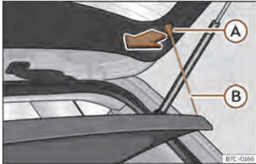
Sl. 111 V prtljažniku: odstranjevanje in nameščanje zadnje police
