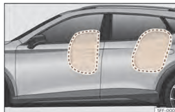
Sl. 22 Popolnoma napihnjeni stranski varnostni blazini na levi strani vozila.
