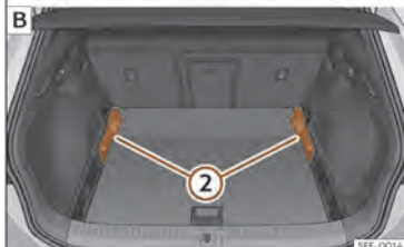
Sl. 115 Variabilno dno prtljažnika: [A] zgornji položaj; [B] spodnji položaj
