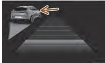
Sl. 161 Na zaslonu kombiniranega instrumenta: ACC aktiven, zaznano vozilo na levi strani
