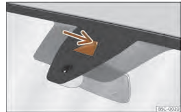
Sl. 150 V vetrobranskem steklu: vidno polje kamere asistense za ohranjanje smeri na voznem pasu Lane Assist.
