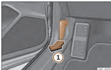
Sl. 205 Ročica za odklepanje v voznikovem prostoru za noge.
