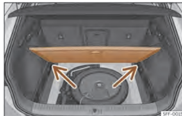
Sl. 116 Variabilno dno prtljažnika: v nagnjenem položaju
