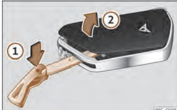
Sl. 73 Ključ vozila: odpiranje pokrova predalčka za baterijo.
