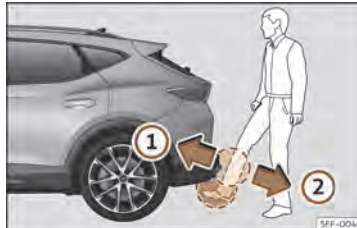
Sl. 85 Senzorsko krmiljeno odpiranje/zapiranje vrat prtljažnika (Easy Open)
