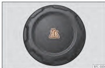
Sl. 214 Motorni prostor: pokrov ekspanzijske posode s hladilno tekočino
