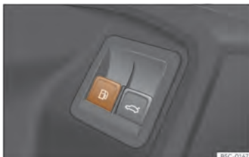
Sl. 201 Voznikova vrata: odklepanje lopute rezervoarja za gorivo.
