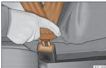
Sl. 9 Jeziček varnostnega pasu vstavite v zaklep.
