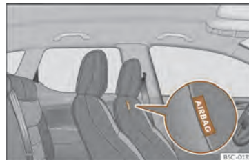
Sl. 19 V blazini sedežnega naslonjala voznikovega sedeža: sredinska varnostna blazina.
