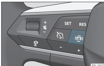
Sl. 58 Leva stran večfunkcijskega volana: tipka za asistenčne sisteme (odvisno od izvedbe).
