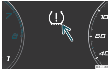
Sl. 196 Kombinirani instrument: opozorilo na izgubo tlaka v pnevmatiki.
