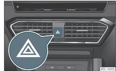
SI. 87 Armaturna plošča: stikalo za opozorilne utripalke
