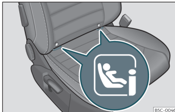
Sl. 28 Sovoznikov sedež: sidrni točki sistema ISOFIX/i-Size.
