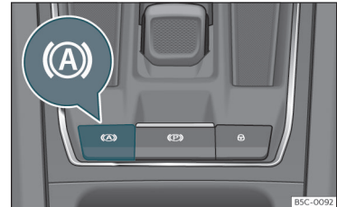
Sl. 168 V spodnjem delu sredinske konzole: tipka za funkcijo Auto Hold.
