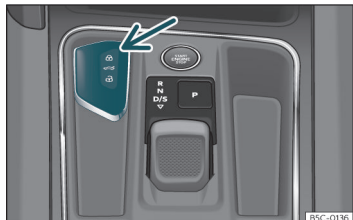
Sl. 66 Sredinska konzola: nastavek za ključ vozila.
