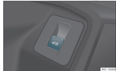
Sl. 79 Voznikova vrata: tipka za odpiranje in zapiranje vrat prtljažnika.
