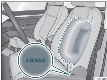
Sl. 21 Stranska varnostna blazina v voznikovem sedežu.
