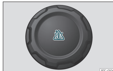
Sl. 189 Motorni prostor: pokrov ekspanzijske posode s hladilno tekočino
