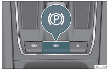
Sl. 167 V spodnjem delu sredinske konzole: tipka za elektronsko parkirno zavoro.
