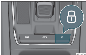
Sl. 71 V sredinski konzoli: tipka centralnega zaklepanja
