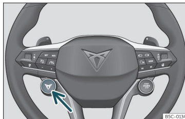
Sl. 139 Večfunkcijski volan*: tipka za spremembo voznega profila.
