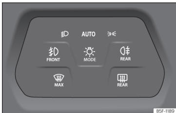
Sl. 85 Armaturna ploščica: stikalo za luči.
