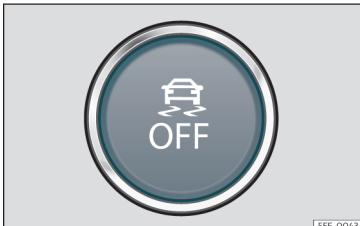
Sl. 169 V spodnjem delu sredinske konzole: tipka za vklop/izklop sistema ESC.
