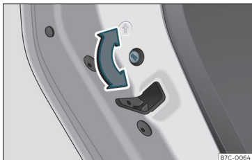
Sl. 76 Otroška blokada v levih vratih
