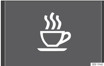
Sl. 52 Na zaslonu kombiniranega instrumenta: simbol sistema za zaznavanje utrujenosti voznika
