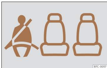
Slika 20 Kombinirani instrument: prikaz statusa varnostnih pasov na zadnjih sedežih.
