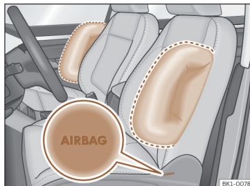
Slika 33 Stranska varnostna blazina v voznikovem in sovoznikovem sedežu.
