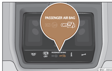
Slika 30 V stropni konzoli: kontrolna lučka za deaktivirano sovoznikovo varnostno blazino.
