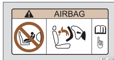
Slika 39 Nalepka z informacijami o varnostni blazini: na sovoznikovem senčniku.
