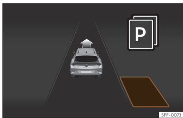
Slika 150 Na zaslonu kombiniranega instrumenta: vizualizacija parkirne asistencе s krmilno avtomatiko z miniaturnimi prikazi
