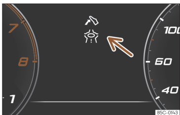
Slika 10 Prikaz asistenčnega sistema za varčno vožnjo (shematski prikaz).
