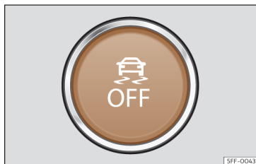
Slika 119 V spodnjem delu sredinske konzole: tipka ESC vklop/izklop
