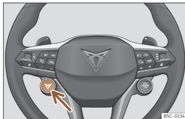
Slika 118 Večfunkcijski volan: tipka za menjavo voznega profila.
