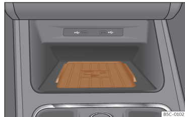
Slika 172 Sredinska konzola: mesto za priključitev mobilnega telefona.
