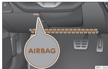
Slika 36 Na voznikovi strani: mesto vgradnje kolenske varnostne blazine.
