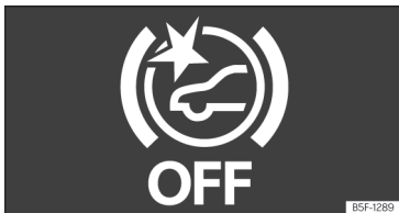
Slika 137 Na zaslonu kombiniranega instrumenta: sporočilo o izklopu sistema Front Assist
