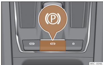
Slika 146 Sredinska konzola, spodnji del: tipka za elektronsko parkirno zavoro.
