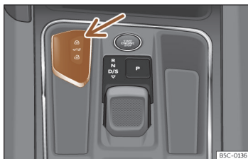
Slika 64 Sredinska konzola: ohišje za ključ vozila.
