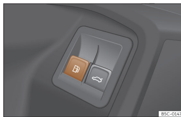
Slika 192 Voznikova vrata: odklepanje lopute rezervoarja za gorivo.
