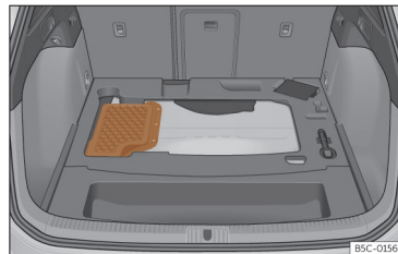
Slika 217 Hibridna vozila (PHEV): akumulator v prtljajniku
