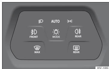
Slika 99 Kombinirani instrument: element za upravljanje luči.
