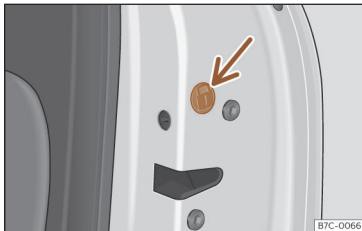
Slika 73 Zasilno zaklepanje vrat.
