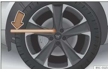
Slika 226 Menjava kolesa: odvijanje kolesnih vijakov.
