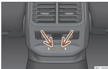
Slika 166 Zadnja sredinska konzola: USB-priključek s funkcijo vtičnice.
