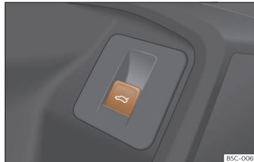
Slika 77 Voznikova vrata: tipka za odpiranje in zapiranje vrat prtljažnika.
