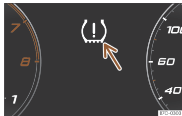
Slika 229 Kombinirani instrument: opozorilo na izgubo tlaka v pnevmatiki.
