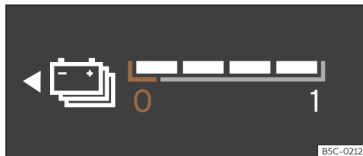
Slika 5 Digitalni kombinirani instrument: prikaz stanja napoljenosti baterije.
