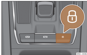
Slika 71 Na sredinski konzoli: stikalo centralnega zaklepanja
