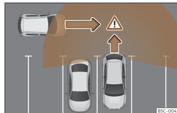
Sl. 172 Shematski prikaz delovanja opozorila na prečni promet zadaj: zaznano območje okrog vozila, ki speljuje.
