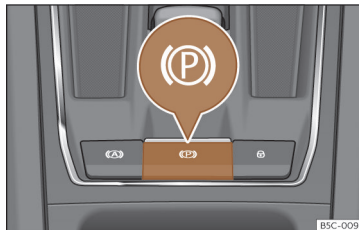
Sl. 175 V spodnjem delu sredinske konzole: tipka za elektronsko parkirno zavoro.
