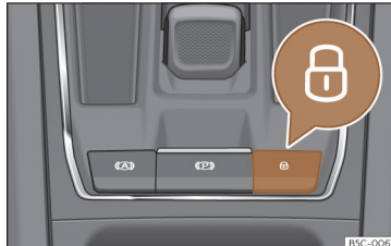
Sl. 76 V sredinski konzoli: tipka centralnega zaklepanja
