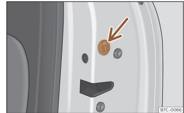
Sl. 80 Zasilno zaklepanje vrat.
