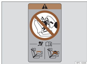
Sl. 26 Nalepka za varnostno blazino: na zadnjem okvirju sovoznikovih vrat
