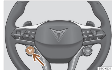
Sl. 147 Večfunkcijski volan: tipka za menjavo voznega profila.
