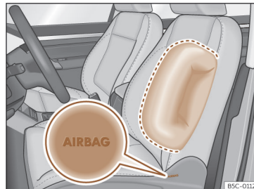
Sl. 21 Stranska varnostna blazina v voznikovem sedežu.
