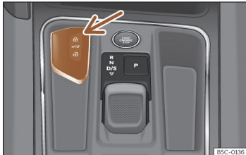
Sl. 71 Sredinska konzola: nastavek za ključ vozila.
