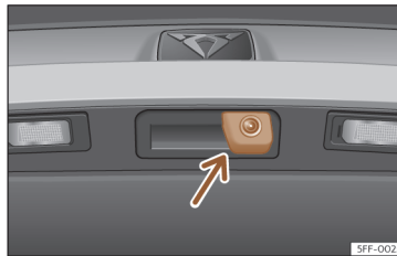
Sl. 153 V ročaju vrat prtljažnika: mesto vgradnje kamere asistenc za vzvratno vožnjo
