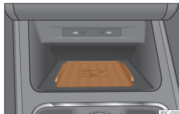
SI. 138 Sredinska konzola: mesto za priključitev mobilnega telefona
