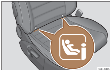
Sl. 28 Sovoznikov sedež: sidrni točki sistema ISOFIX/i-Size.
