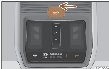
Sl. 32 V stropni konzoli: tipke za glasovne storitve.
