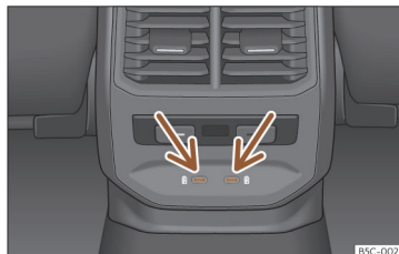
Sl. 140 Zadnji del sredinske konzole: USB-priključek s funkcijo vtičnice.
