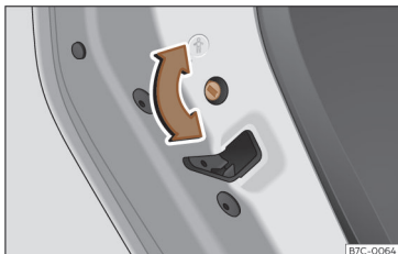
Sl. 81 Otroška blokada v levih vratih
