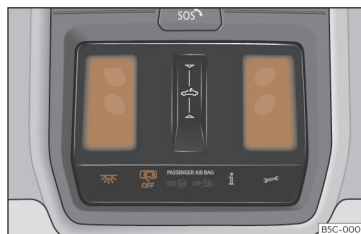
Sl. 94 Del stropne obloge: notranja osvetlitev spredaj
