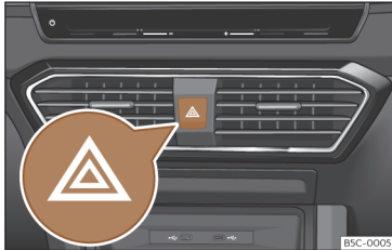
Sl. 93 Armaturna plošča: stikalo za opozorilne utripalke
