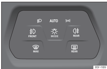
Sl. 91 Armaturna plošča: stikalo za luči.
