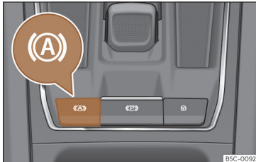
Sl. 176 V spodnjem delu sredinske konzole: tipka za funkcijo Auto Hold.
