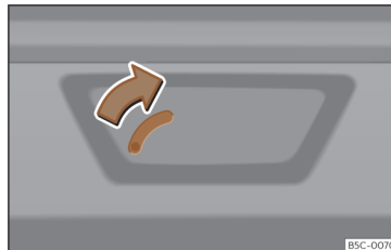
Sl. 91 Detajl prtljažnega prostora: ročni mehanizem za zasilno odklepanje (Leon Sportstourer).
