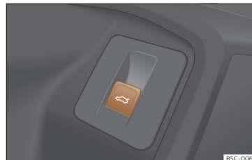
Sl. 88 Voznikova vrata: tipka za odpiranje in zapiranje vrat prtljažnika.
