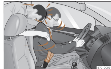
Sl. 12 Nepriprtega sopotnika na zadnjem sedežu vrže naprej v pripetega voznika.
