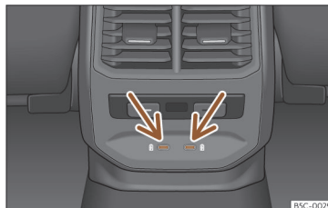
Sl. 153 Zadnji del sredinske konzole: USB-priključek s funkcijo vtičnice.
