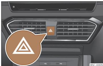
Sl. 97 Armaturna plošča: stikalo za opozorilne utripalke
