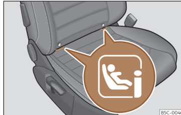
Sl. 32 Sovoznikov sedež: sidrni točki sistema ISOFIX/i-Size.
