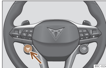
Sl. 159 Večfunkcijski volan: tipka za menjavo voznega profila.
