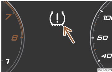
Sl. 232 Kombinirani instrument: opozorilo na izgubo tlaka v pnevmatiki.
