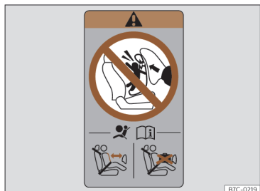
Sl. 30 Nalepka za varnostno blazino: na zadnjem okvirju sovoznikovih vrat
