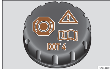
Sl. 225 Motorni prostor: pokrovček posode z zavorno tekočino.
