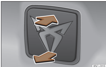
Sl. 86 Vrata prtljažnika: odpiranje z zunanje strani.
