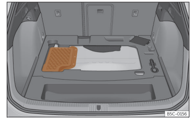
Sl. 227 Hibridna vozila (PHEV): akumulator v prtljažniku
