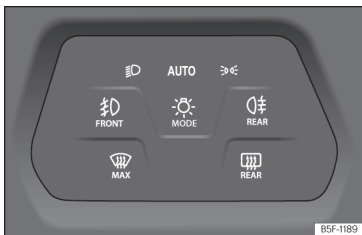
Sl. 95 Armaturna plošča: stikalo za luči.
