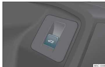
Sl. 83 Voznikova vrata: tipka za odpiranje in zapiranje vrat prtljažnika.
