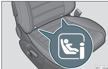
Sl. 28 Sovoznikov sedež: sidrni točki sistema ISOFIX/i-Size.
