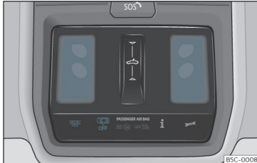
Sl. 92 Del stropne obloge: notranja osvetlitev spredaj
