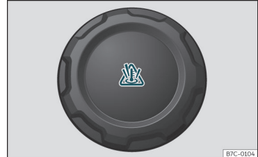
Sl. 207 Motorni prostor: pokrov ekspanzijske posode s hladilno tekočino
