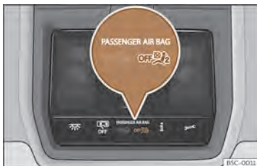
Sl. 20 V stropni konzoli: kontrolna lučka za deaktivirano sovoznikovo čelno varnostno blazino.
