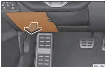
Sl. 51 Na voznikovi strani armaturne plošče: pokrov postaje z varovalkami.
