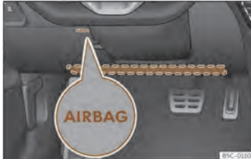
Sl. 21 Na voznikovi strani: mesto vgradnje kolenske varnostne blazine.
