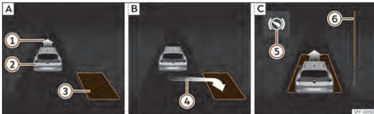
Sl. 192 Na zaslonu v kombiniranem instrumentu: bočno parkiranje. [A] Iskanje prostega parkirnega mesta. [B] Položaj za parkiranje. [C] Maneviranje.
