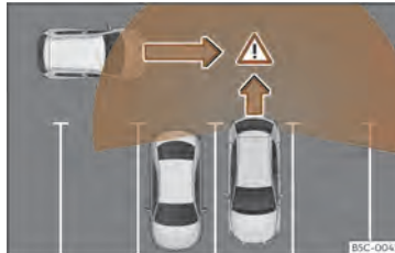
Sl. 184 Shematski prikaz delovanja opozorila na prečni promet zadaj: zaznano območje okrog vozila, ki speljuje.
