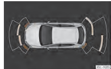
Sl. 196 Prikazi parkirnega sistema na zaslonu infotainment sistema.
