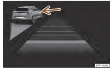
Sl. 173 Na zaslonu kombiniranega instrumenta: ACC aktiven, zaznano vozilo na levi strani
