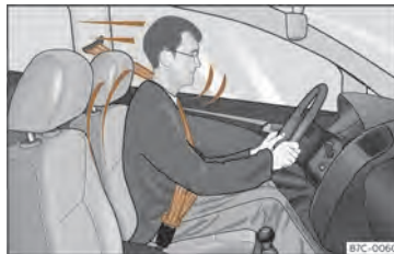
Sl. 10 Pripet voznik, ki ga ob nenadnem sunkovitem zaviranju zadrži pravilno pripet varnostni pas.
