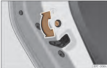
Sl. 85 Otroška blokada v levih vratih
