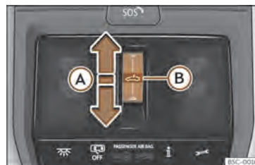
Sl. 93 V stropni oblogi: tipka za panoramsko pomično strešno okno.
