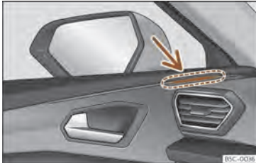
Sl. 180 Kontrolna lučka asistencije za opozarjanje na vozila v mrtvem kotu.
