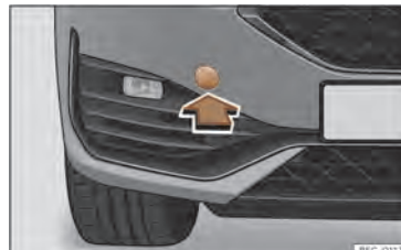
Sl. 47 Sprednji odbijač desno: pokrovček.
