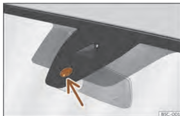
Sl. 102 Površina zaznavanja senzorja za dež
