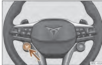
SI. 159 Večfunkcijski volan: tipka za menjavo voznega profila.
