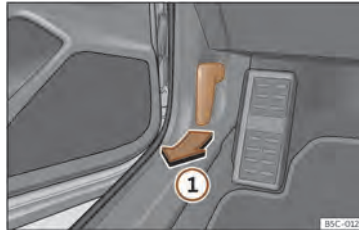
Sl. 215 Ročica za odklepanje v voznikovem prostoru za noge.
