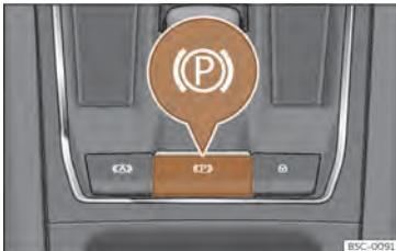
Sl. 187 V spodnjem delu sredinske konzole: tipka za elektronsko parkirno zavoro.
