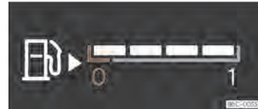
Sl. 63 Prikazovalnik količine goriva na različnih lokacijah glede na prikaz.
