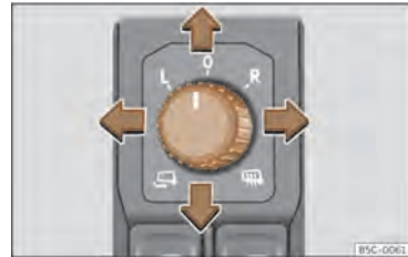
Sl. 103 Del vozniških vrat: vrtljivi gumb za upravljanje zunanjih vzvratnih ogledal
