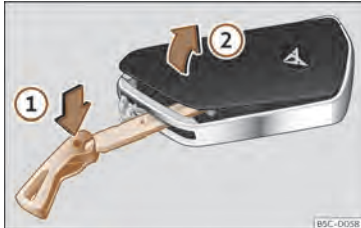
Sl. 77 Ključ vozila: odpiranje pokrova predalčka za baterijo.
