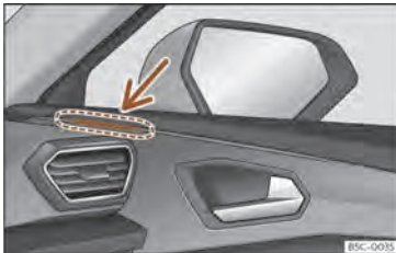
Sl. 181 Kontrolna lučka asistencije za opozarjanje na vozila v mrtvem kotu.
