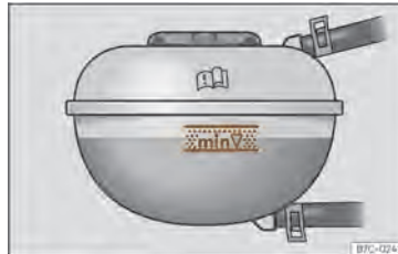
Sl. 223 V motornem prostoru: oznaka na ekspanzijski posodi s hladilno tekočino
