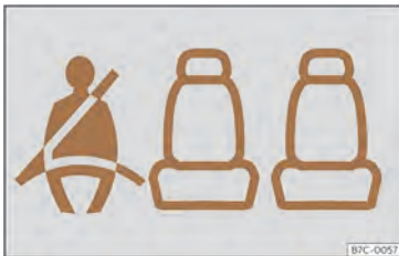
Sl. 9 Kombinirani instrument: prikaz, da je prostor zadaj desno zaseden in da je pripet ustrezni varnostni pas.
