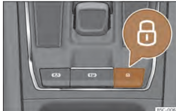
Sl. 80 V sredinski konzoli: tipka centralnega zaklepanja
