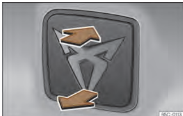
Sl. 86 Vrata prtljažnika: odpiranje z zunanje strani.
