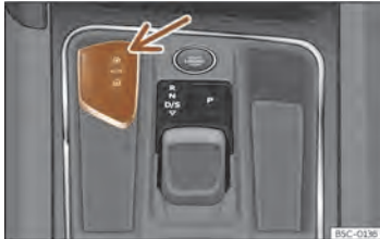
Sl. 75 Sredinska konzola: nastavek za ključ vozila.
