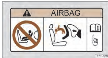
Sl. 29 Nalepka za varnostno blazino: na sovoznikovem senčniku
