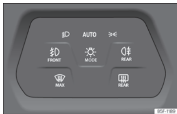
Sl. 95 Armaturna plošča: stikalo za luči.
