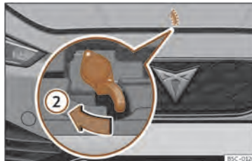
Sl. 216 Ročica pod pokrovom motornega prostora.
