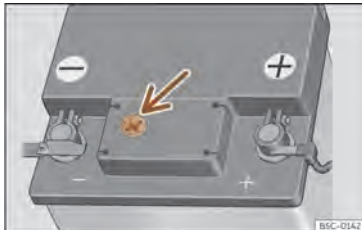
Sl. 228 Vidno okence na zgornji strani 12-voltnega akumulatorja (shematski prikaz).
