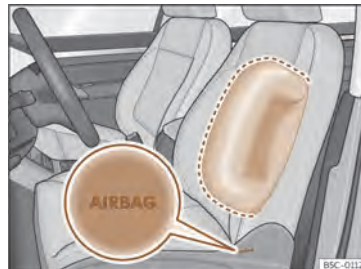
Sl. 25 Stranska varnostna blazina v voznikovem sedežu.
