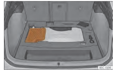
Sl. 227 Hibridna vozila (PHEV): akumulator v prtljažniku
