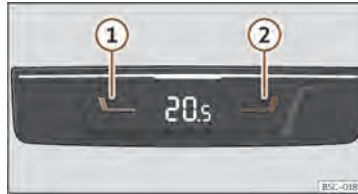
Sl. 145 Zadnji del sredinske konzole: tipki za zadnje sežeže.
