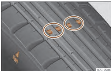
Sl. 230 Profil pnevmatike: oznake obrabljenosti
