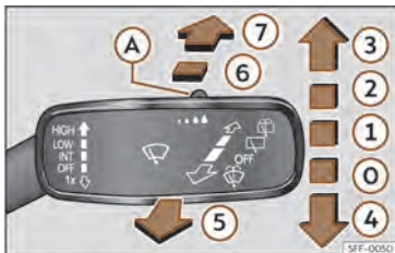
Sl. 100 Upravljanje z brisalci vetrobranskega in zadnjega stekla
