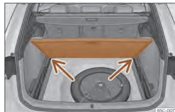
Sl. 124 Variabilno dno prtljažnika: v nagnjenem položaju
