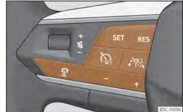
Sl. 179 Leva stran večfunkcijskega volana: tipke za upravljanje asistence Travel Assist.
