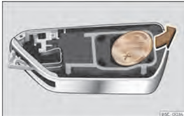
Sl. 78 Ključ vozila: odstranjevanje baterije.
