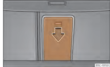
Sl. 131 Prtljažnik: odpiranje pokrova odprtine za prevoz daljših predmetov.
