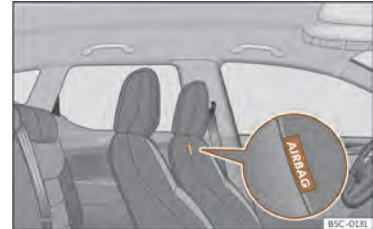
Sl. 23 V blazini sedežnega naslonjala voznikovega sedeža: sredinska varnostna blazina.
