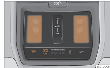
Sl. 83 Del stropne obloge: notranja osvetlitev spredaj
