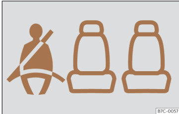
Sl. 15 Kombinirani instrument: prikaz statusa za varnostne pasove na zadnjih sedežih
