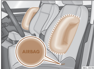
Sl. 29 Stranska varnostna blazina v vozni-kovem in sovoznikovem sedežu.
