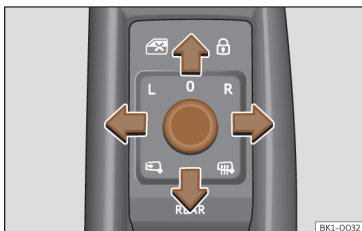
Sl. 88 Del voznikovih vrat: vrtljivi gumb za upravljanje zunanjih vzratnih ogledal
