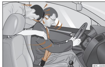
Sl. 18 Nepriprtega sopotnika na zadnjem sedežu vrže naprej v pripetega voznika.
