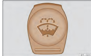
Sl. 160 V prostoru spredaj: pokrov posode s tekočino za čiščenje stekel.
