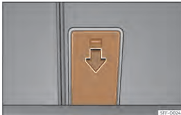
Sl. 142 Prtljažnik: odpiranje pokrova odprtine za prevoz daljših predmetov.
