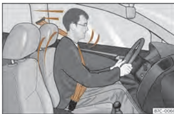
Sl. 16 Pripet voznik, ki ga ob nenadnem sunkovitem zaviranju zadrži pravilno pripet varnostni pas.
