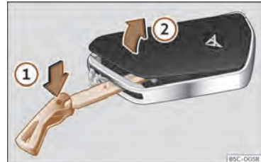
Sl. 58 Ključ vozila: odpiranje pokrova predalčka za baterijo.
