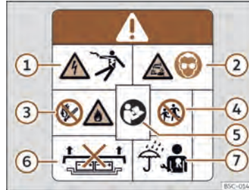
Sl. 44 Opozorilne nalepke za visokonapetostno baterijo.
