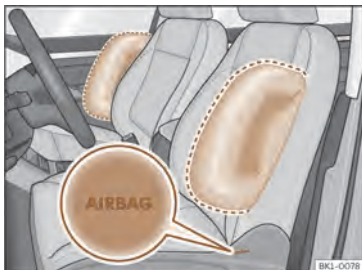
Sl. 29 Stranska varnostna blazina v vozniškovem in sovoznikovem sedežu.
