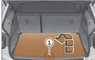
Sl. 137 V prtljažniku: odpiranje drugega dna prtljažnika.
