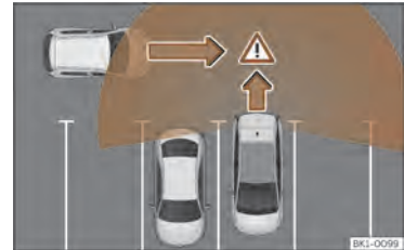
Sl. 115 Shematski prikaz delovanja opozorila na prečni promet zadaj: zaznano območje okrog vozila, ki speljuje.
