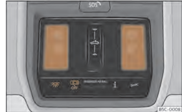
Sl. 83 Del stropne obloge: notranja osvetlitev spredaj
