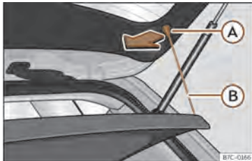
Sl. 134 V prtljažniku: odstranjevanje in nameščanje zadnje police
