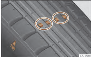
Sl. 162 Profil pnevmatike: oznake obrabljenosti
