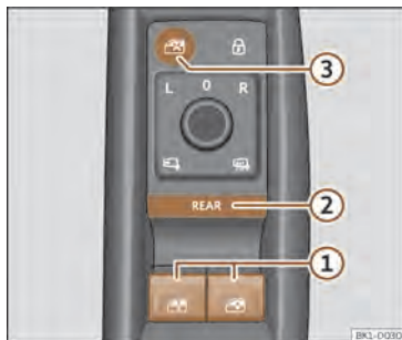
Sl. 69 Del voznikovih vrat: elementi za upravljanje električnega pomika sprednjih in zadnjih stekel.
