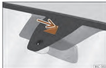
Sl. 97 V vetrobranskem steklu: vidno polje kamere asistense za ohranjanje smeri na voznem pasu Lane Assist.
