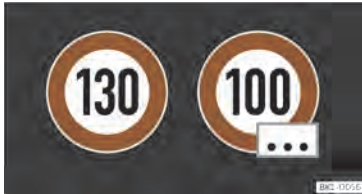
Sl. 7 Na zaslonu kombiniranega instrumenta: primer omejitev hitrosti s splošnimi dodatnimi prometnimi znaki.
