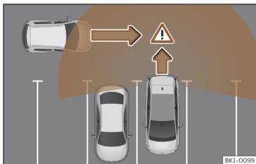
Slika 138 Shema asistencije za odparkiranje: zaznano območje okrog vozila, ki speljuje.
