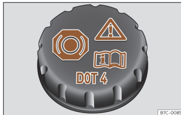
Slika 177 Prostor spredaj: pokrov posode z zavorno tekočino.
