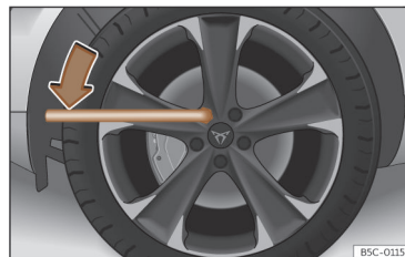
Slika 184 Menjava kolesa: odvijanje kolesnih vijakov.
