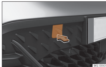
Slika 167 Na desni strani sprednjega odbijača: odstranjevanje obloge.
