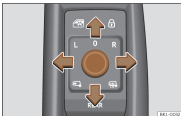
Slika 94 Del vozniških vrat: upravljanje zunanjih vzratnih ogledal.
