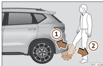
Slika 57 Senzorsko krmiljeno odpiranje vrat prtljažnika (Easy Open)
