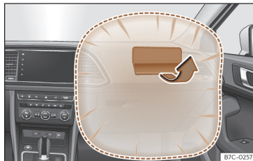
Slika 24 Sovoznikova varnostna blazina v armaturni plošči.
