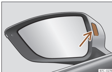
Slika 120 Kontrolna lučka asistenc za opozarjanje na vozila v mrtvem kotu.
