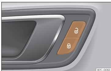
Slika 49 Na vozniških vratih: stikalo centralnega zaklepanja.
