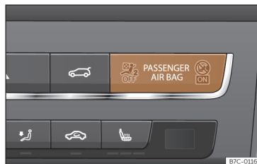
Slika 26 Armaturna plošča: kontrolna lučka za izključeno sovoznikovo čelno varnostno blazino v sredinski konzoli.
