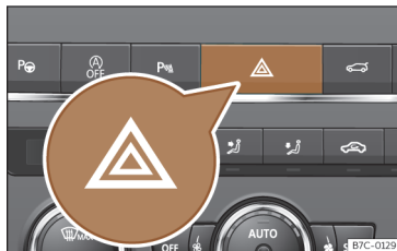
Slika 40 Armaturna plošča: stikalo za opozorilne utripalke.
