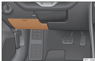
Slika 187 Na voznikovi strani armaturne plošče: pokrov postaje z varovalkami.
