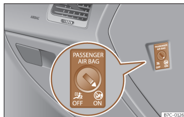
Slika 25 Stikalo za aktiviranje in deaktiviranje sovoznikove čelne varnostne blazine.
