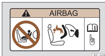
Slika 33 Nalepka z informacijami o varnostni blazini: na sovoznikovem senčniku.
