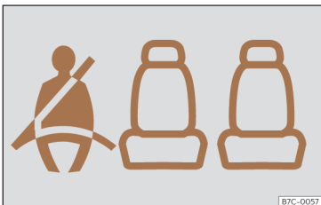
Slika 16 Kombinirani instrument: prikaz statusa varnostnih pasov na zadnjih sedežih.
