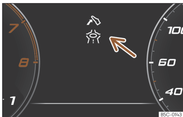
Slika 7 Prikaz asistenčnega sistema za varčno vožnjo (shematski prikaz).
