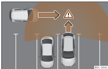
Slika 143 Shema asistencije za odparkiranje: zaznano območje okrog vozila, ki speljuje.
