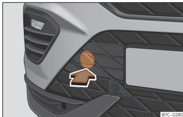
Slika 183 Na desni strani sprednjega odbijača: odstranjevanje obloge.
