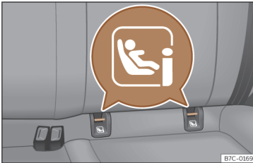
Slika 35 Zadnji sedež: lokacija sidrnih točk sistema ISO-FIX ali i-Size.
