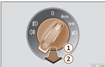
Slika 79 Kombinirani instrument: element za upravljanje luči.
