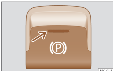
Slika 124 Sredinska konzola, spodnji del: tipka za elektronsko parkirno zavoro.
