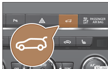
Slika 56 Sredinska konzola: tipka za odpiranje in zapiranje vrat prtljažnika.
