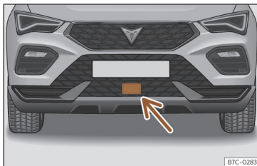
Slika 101 V sprednjem odbijaču: radarski senzor.
