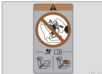
Slika 34 Nalepka z informacijami o varnostni blazini: na zadnjem okvirju sovoznikovih vrat.
