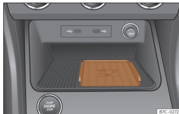
Slika 156 Sredinska konzola: mesto za priključitev mobilnega telefona.
