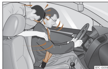
Slika 18 Nepriprtega sopotnika na zadnjem sedežu vrže naprej v priprtega voznika.
