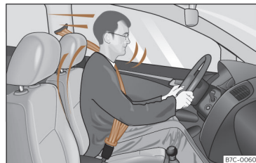
Slika 15 Pripet voznik, ki ga ob nenadnem sunkovitem zaviranju zadrži pravilno pripet varnostni pas.
