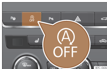
Slika 91 Sredinska konzola: sistemska tipka start-stop.
