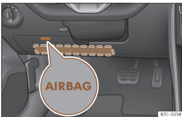
Slika 30 Na voznikovi strani: mesto vgradnje kolenske varnostne blazine.
