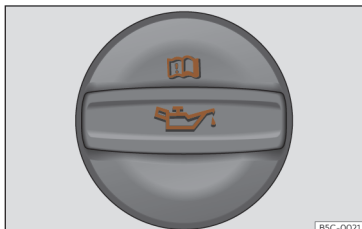
Slika 200 Pokrov odprtine za dolivanje motornega olja v motornem prostoru.
