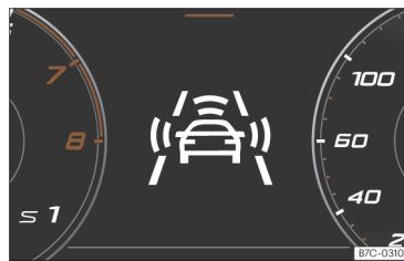
Slika 114 Na zaslonu kombiniranega instrumenta: prikaz predhodnega opozorila
