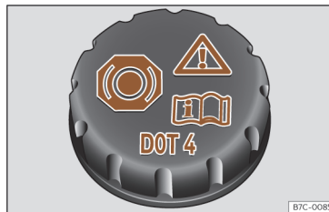
Slika 195 Motorni prostor: pokrovček posode z zavorno tekočino.
