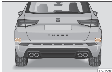
Slika 104 Območje za vozilom: območja radarskih senzorjev
