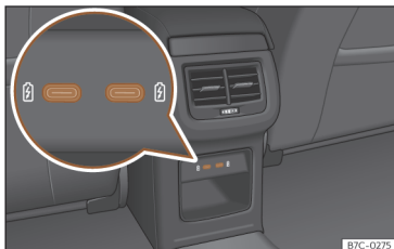
Slika 150 Zadnja sredinska konzola: USB-priključek s funkcijo vtičnice.
