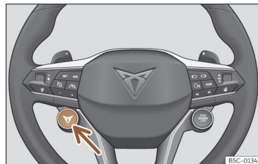
Slika 97 Večfunkcijski volan: tipka za menjavo voznega profila.
