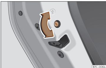
Slika 53 Otroška blokada v levih vratih.
