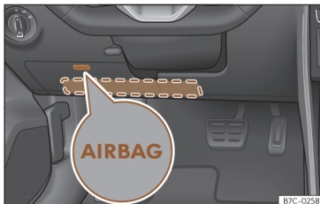
Sl. 17 Na voznikovi strani: mesto vgradnje kolenske varnostne blazine.
