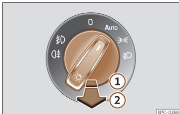
Sl. 88 Armaturna plošča: stikalo za luči.
