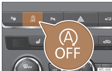
Sl. 136 Sredinska konzola: sistemska tipka start-stop
