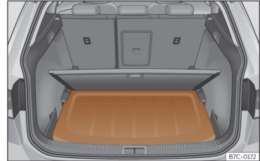
Sl. 108 V prtljažniku: shranjevanje zadnje police pod dno prtljažnika.
