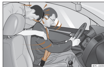
Sl. 8 Nepriprtega sopotnika na zadnjem sedežu vrže naprej v pripetega voznika.
