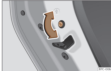
Sl. 76 Otroška blokada v levih vratih
