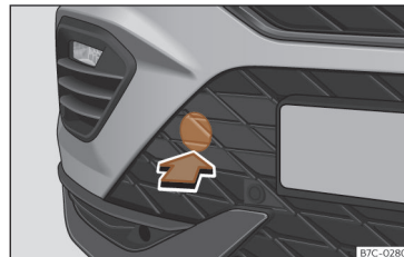
Sl. 41 Sprednji odbijač desno: pokrovček.
