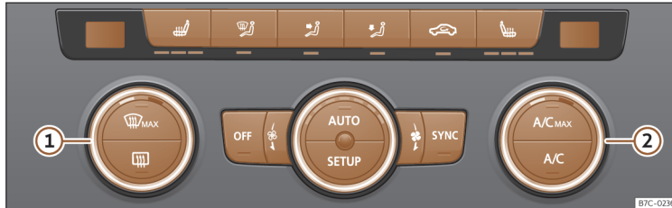
Sl. 124 V sredinski konzoli: elementi za upravljanje Climatronica
