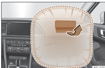
Sl. 14 Sovoznikova varnostna blazina v armaturni plošči.
