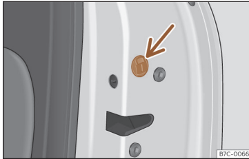
Sl. 75 Zasilno zaklepanje vrat.
