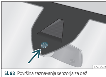
Sl. 98 Površina zaznavanja senzorja za dež A
