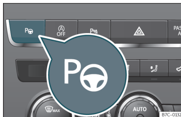
Sl. 177 V sredinski konzoli zgoraj: tipka za vklop parkirne krmilne asistence Park Assist.
