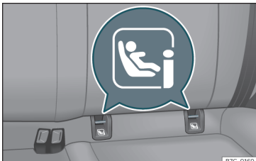
Sl. 25 Zadnji sedež: sidrni točki sistema ISOFIX/i-Size. B7C-0169
