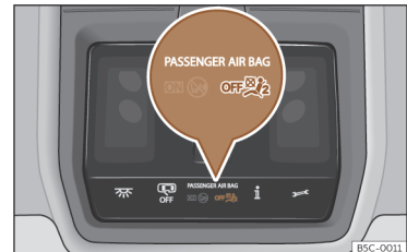
Fig. 20 Pe consola plafonului: lampa de control pentru dezactivarea airbagului frontal al pasagerului față.
