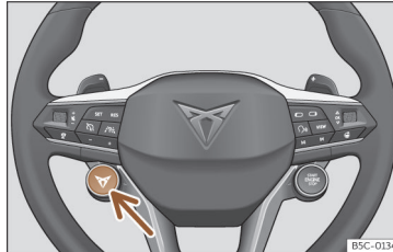
Fig. 159 Volan multifuncțional: buton pentru schimbarea profilului de conducere.
