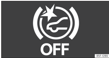
Fig. 170 Pe afișajul panoului de instrumente: indicație Front Assist dezactivat.
