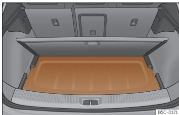
Fig. 118 În portbagaj: montarea copertinei portbagajului.
