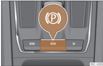
Fig. 187 În partea inferioară a consolei centrale: butonul frânei electronice de parcare
