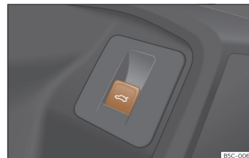
Fig. 88 De pe ușa șoferului: butonul de deschidere și închidere a hayonului.
