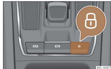
Fig. 80 Pe consola centrală: butonul de închidere centralizată
