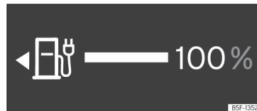
Fig. 62 Panoul digital de instrumente: indicator nivel baterie.
