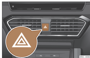
Fig. 97 Planșa de bord: butonul pentru luminile de avarie
