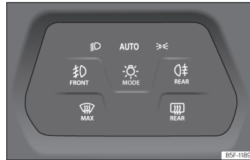
Fig. 95 Planașă de bord: comutatorul de lumini.
