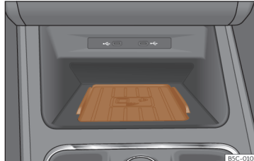
Fig. 151 În consola centrală: suportul pentru conectarea telefonului mobil.
