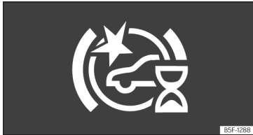
Fig. 169 Pe afișajul panoului de instrumente: indicator privind autocalibrarea inițială a sistemului.
