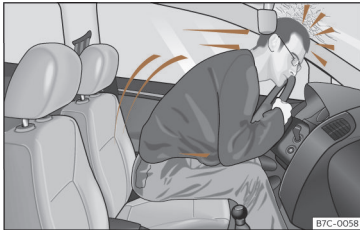
Fig. 11 Un șofer care nu poartă centura de siguranță este proiectat violent înainte.
