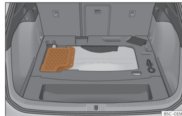
Fig. 227 Automobile hibride (PHEV): amplasarea bateriei în portbagaj
