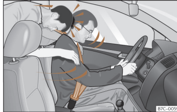
Fig. 12 Pasagerul din spate cu centura de siguranță nefixată este proiectat violent înainte și lovește șoferul ce poartă centura de siguranță.
