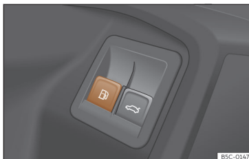
Fig. 212 Ușa șoferului: deblocare clapetă rezervor.
