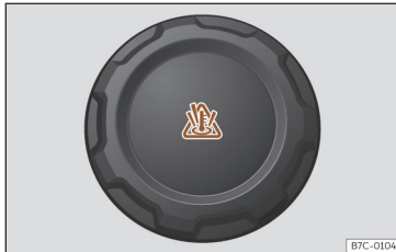
Fig. 224 Compartimentul motor: capacul vasului de expansiune pentru lichidul de răcire.
