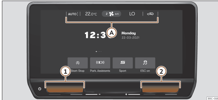
Fig. 143 Reprezentarea schematică: funcțiile climatizării
