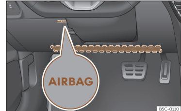
Fig. 21 Pe partea șoferului: amplasarea airbagului pentru genunchi
