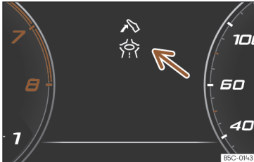
Fig. 59 Indicator asistență la conducere eficientă ecologic (representare schematică).
