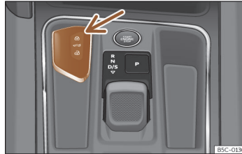
Fig. 75 Consola centrală: butucul pentru cheia automobilului.
