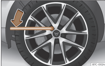
Fig. 41 Schimbarea roții: slăbirea piulițelor de roată.
