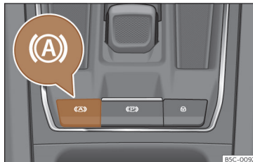
Fig. 188 În partea inferioară a consolei centrale: Suprafața de comandă funcției Auto Hold.
