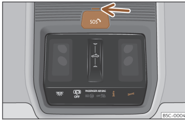
Fig. 36 Pe consola plafonului: comenzile serviciului voce
