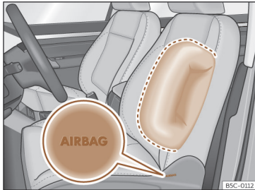
Fig. 25 Airbagul lateral din scaunul șoferului.
