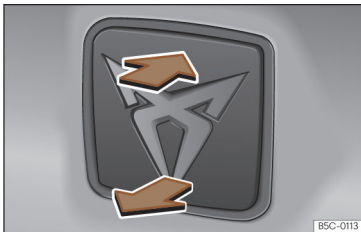
Fig. 86 Hayonul: deschiderea din exterior.
