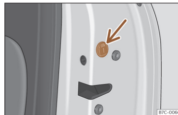
Fig. 84 Încuierea manuală a ușilor.
