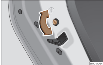
Fig. 85 Siguranța pentru copii pe ușa din stânga.
