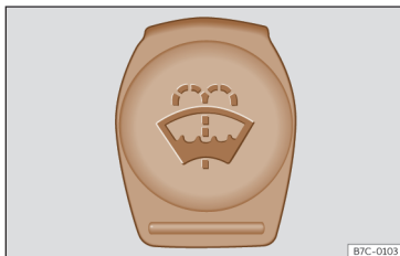
Fig. 226 În compartimentul motor: capacul rezervorului spălătorului geamurilor.
