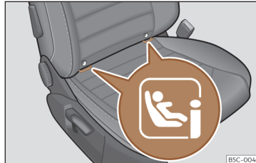
Fig. 32 Scaunul pasagerului față: inelele de ancorare ISOFIX/i-Size.
