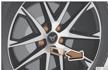
Fig. 39 Roata: piulițele de roată cu capace.
